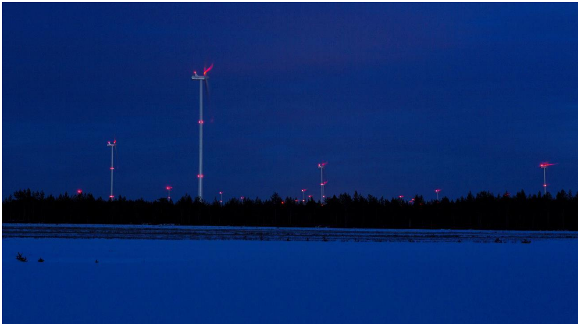
Kuva 25. Kiinteät punaiset lentoestevalot pimeällä. (Kuva: Ville Suorsa/FCG)
